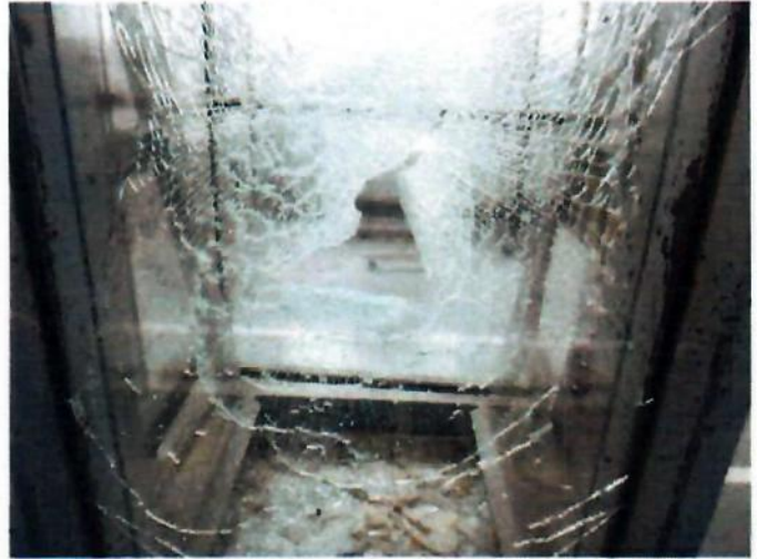
Geam N°2, Înălțimea căderii: 1200 mm
