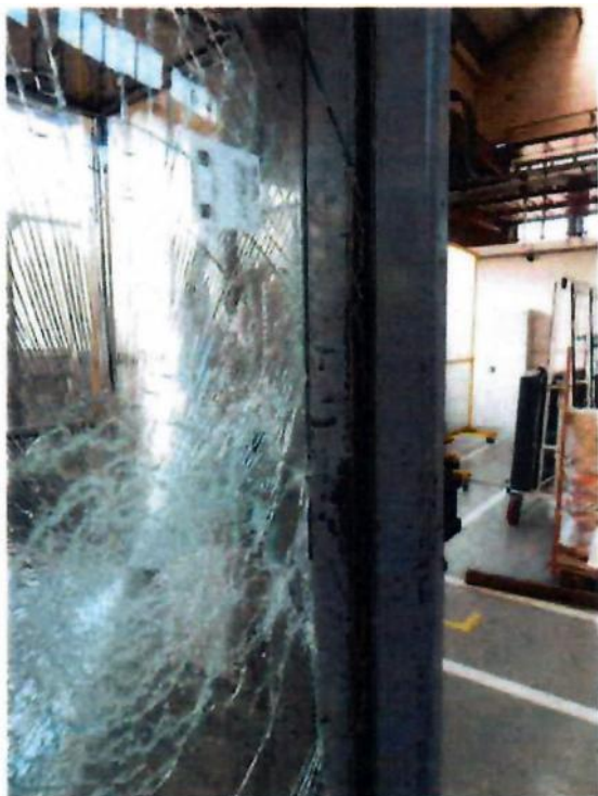
Geam N°1, Înălțimea căderii 1200 mm
