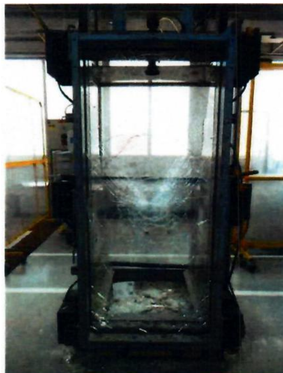
Geam N°4, Înălțimea căderii 450 mm
