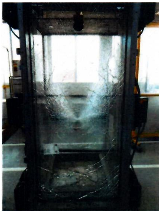
Geam N°3, Înălțimea căderii 450 mm
