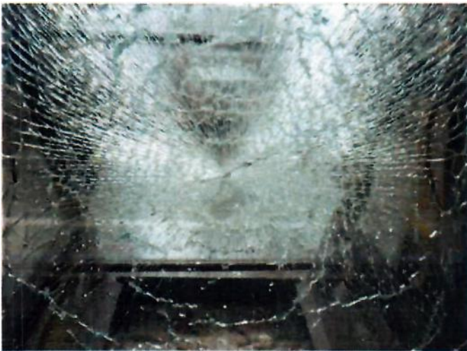
Geam N°3, Înălțimea căderii: 450 mm
