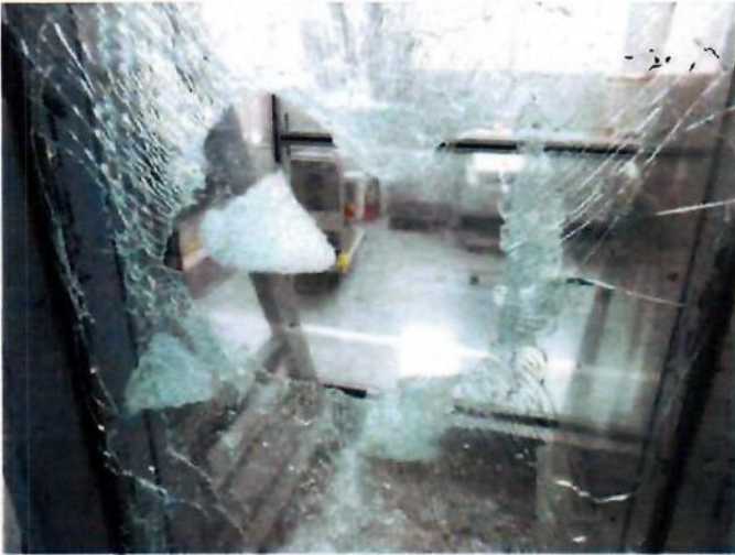
Geam N°1, înălțimea căderii: 1200 mm
