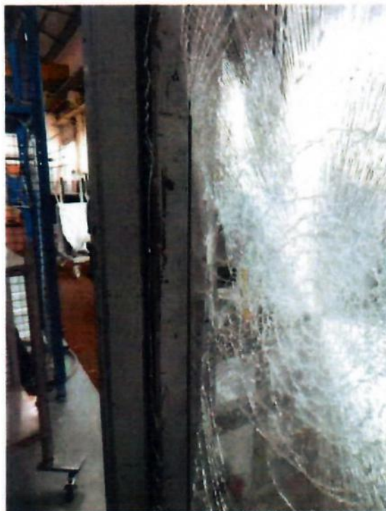
Geam N°2, Înălțimea căderii 1200 mm
